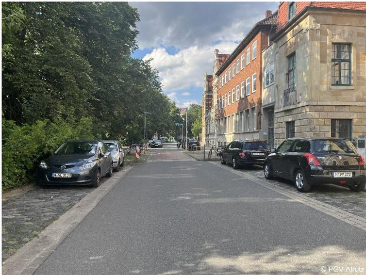
Abb. 1-4: Fahrbahneinengung mit Aufpflasterung zur Geschwindigkeitsreduzierung
