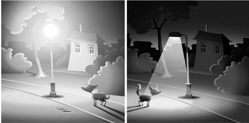
Abb. 4-21: Illustration der Abstrahlungsgeometrie. Links: Darstellung einer Kugelleuchte, ohne Abschirmung. Rechts: abgeschirmte Straßenleuchte.
