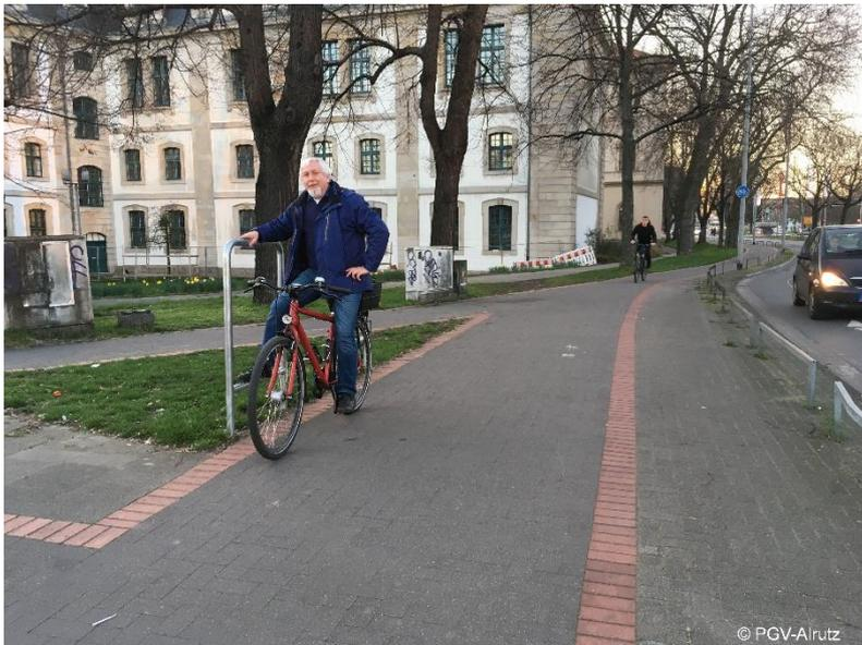
Abb. 4-30: Bügel als „Wartehilfe“ vor einer Lichtsignalanlage (Hannover)
