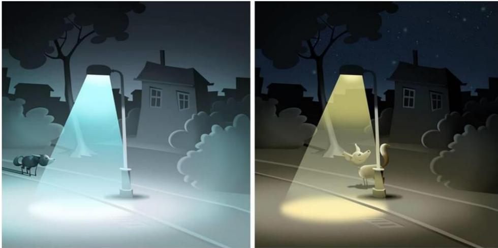
Abb. 4-22: Illustration der Lichtfarbe. Links: kaltweiße Beleuchtung mit hohem Blauanteil. Rechts: Warmweiße Beleuchtung mit geringem Blauanteil.
